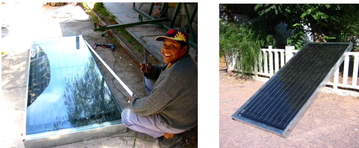
Abbildung 6: Warmwasserkollektoren gebaut von der Kooperative PIRCA/Tilcara
