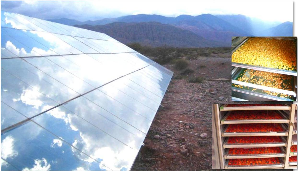
Figura 28: Secador de 60m<sup>2</sup> para la cooperativa de Yacoraite/Argentina
