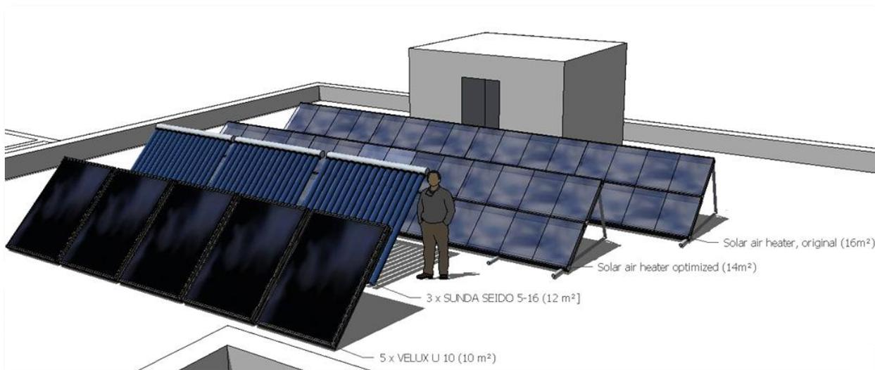
Figura 5: Tamaños de colectores planos, tubos de vacío y calentadores solares de aire con rendimiento similar
