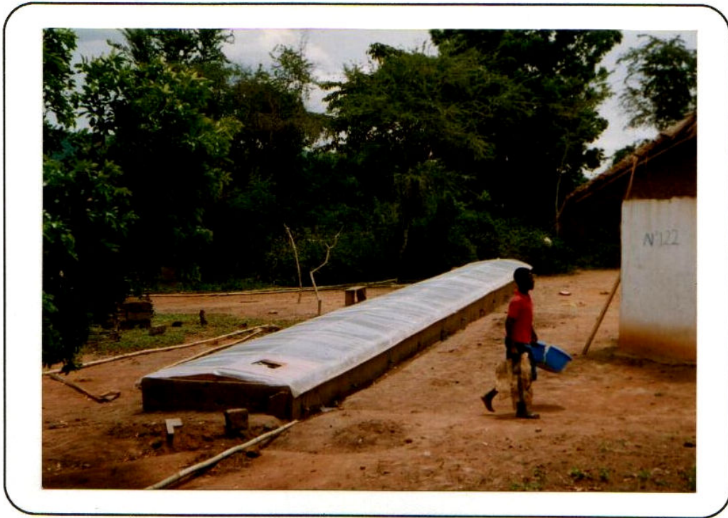
Der fertige Trockner wird von einem Autoventilator durchgeblasen. Dieser bezieht seine Energie von einem 50 W Solarmodul.
