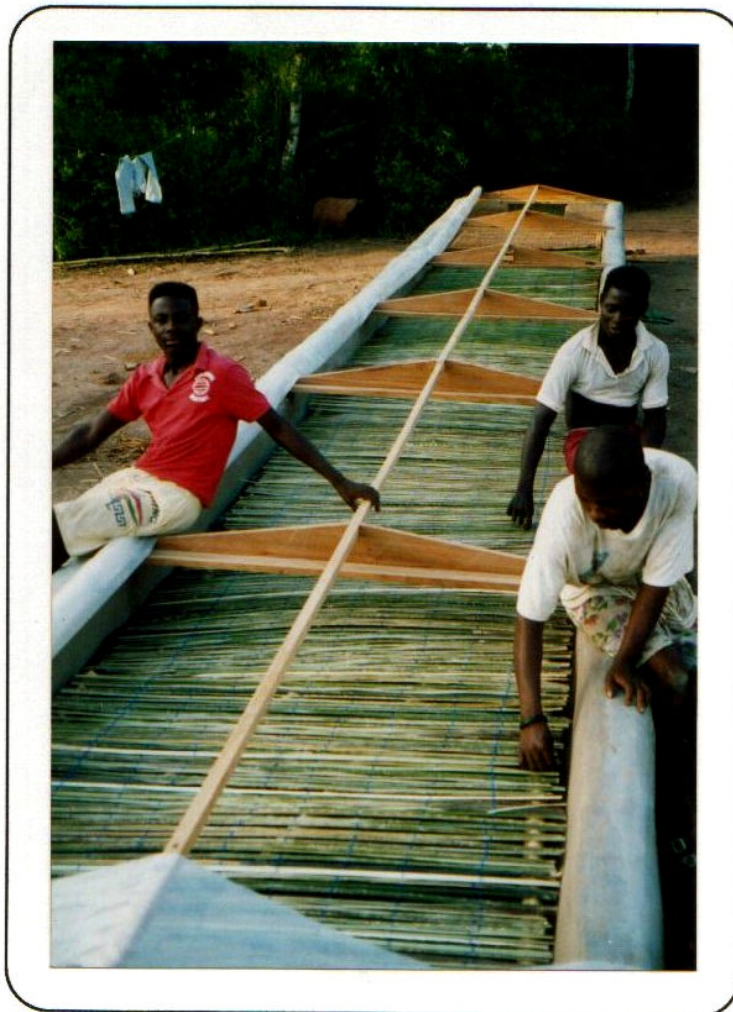
Als Unterlage für das Trockengut dient eine Matte aus Palmstöcken, die hier mit einem primitiven Webstuhl geflochten wird.
